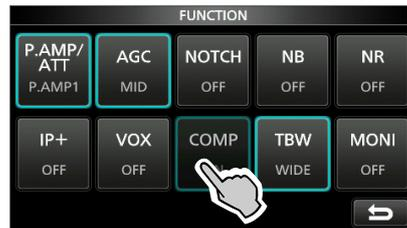
11. Tout en parlant dans le microphone à un niveau vocal normal, ajuster le Compresseur Vocal de sorte que la mesure COMP soit affichée dans la zone COMP (page 10 à 20 dB).
